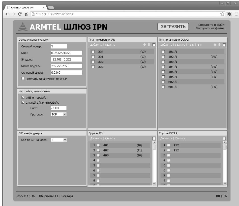
Рисунок 6 – WEB-интерфейс конфигурации IP-шлюза
