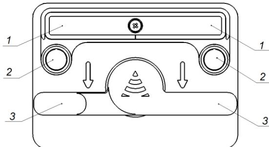
1 – панелька маркировочная; 2 – светодиод для индикации режимов работы;
