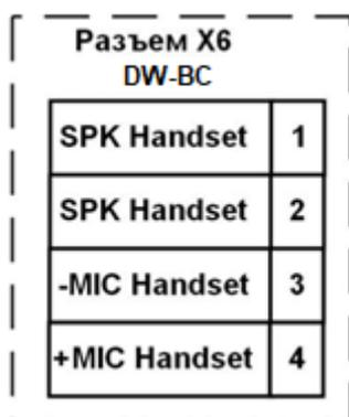
*Рисунок Б.1 – Подключение трубки*
