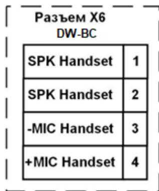
*Рисунок Б.1 – Подключение трубки*
